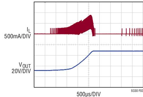
**Figure 3. Soft-Start Waveforms**
