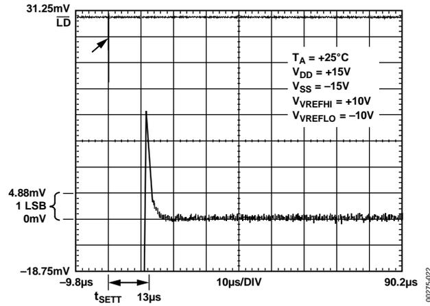
Figure 21. Positive Settling Time ( $\pm 15$  V)
