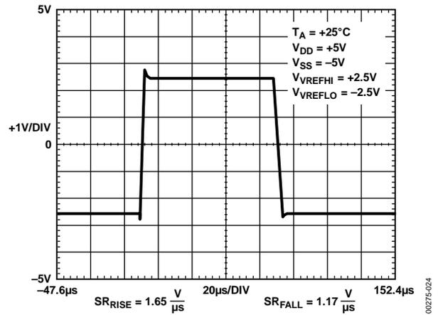
Figure 23. Slew Rate ( $\pm 5$  V)
