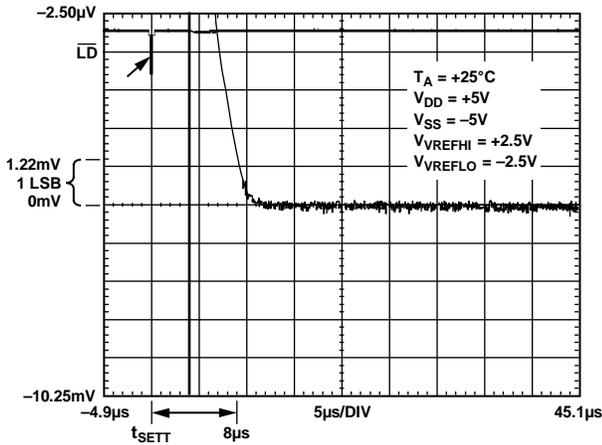
Figure 19. Positive Settling Time ( $\pm 5$  V)
