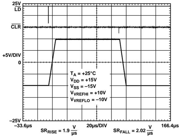
Figure 24. Slew Rate ( $\pm 15\text{ V}$ )
