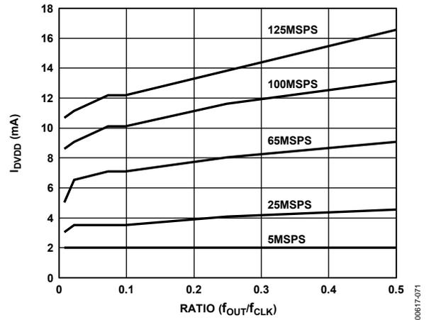
Figure 71.  $I_{DVDD}$  vs. Ratio @  $DVDD1 = DVDD2 = 3.3 V$
